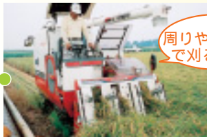
コンバインで稲を刈ります。モミだけ取って茎はカットして後ろからはき出し、土に戻します
