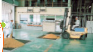
トラックが一杯になったらJAの「コントリーエレベーター」へ運んで、モミを地下に落としてラインに乗せます。ここは大きな乾燥機と貯蔵庫がエレベーターでつながった、お米を管理する工場です
